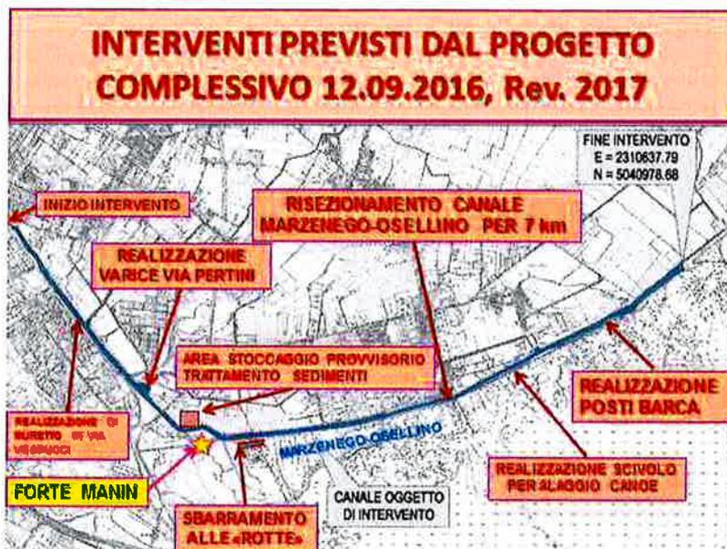
Fig. n. 3 - Interventi previsti dal progetto definitivo complessivo datato 12.09.2016 – Rev-sett.2017.
